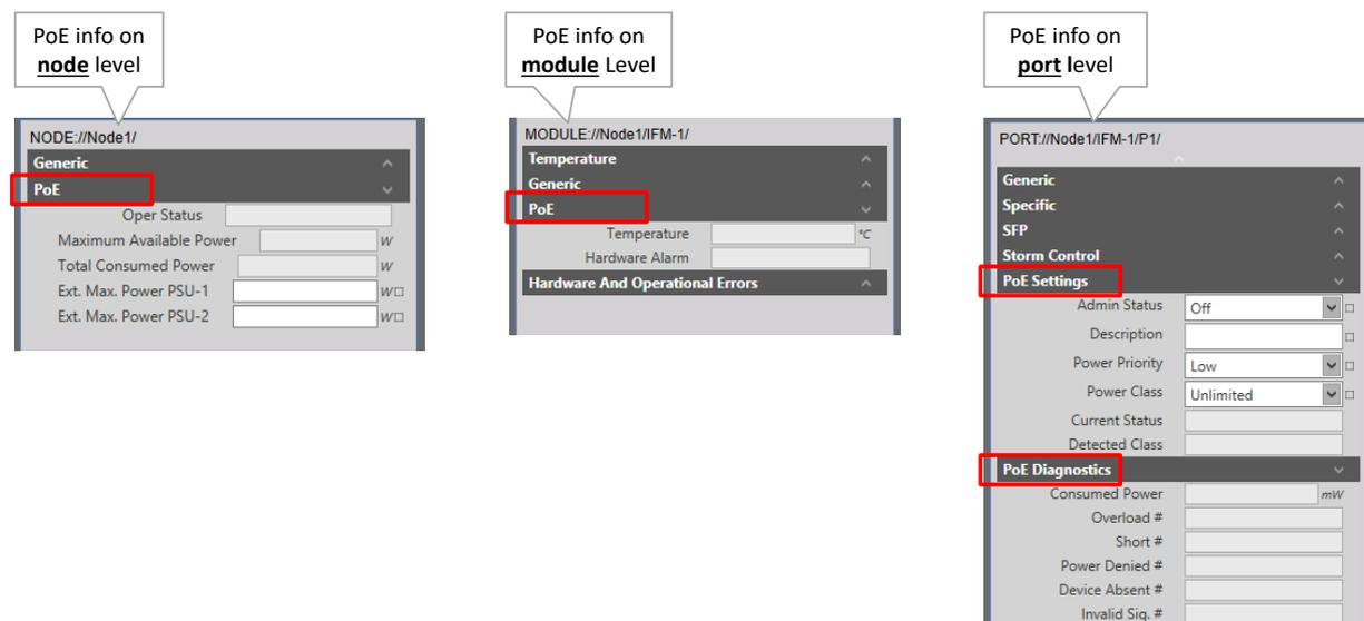
Figure 135 PoE Info on Node/Module/Port Level
