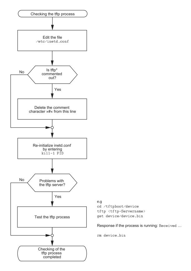
\*tftp dgram udp wait root/usr/etc/in.tftpd in.tftpd /tftpboot
